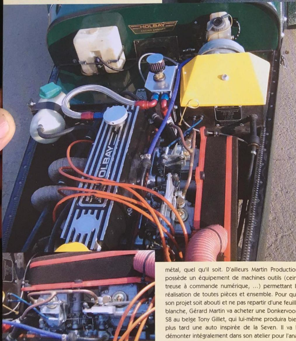
Sur notre exemplaire du jour, le bloc Ford 1,6 litres provenant d'une Sierra a cédé sa place à un autre moteur Ford pour des commodités de transmissions, mais en version 2.0 litres avec des modifications sur la distribution et l'alimentation.
